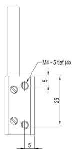
Alle Abmessungen in mm
