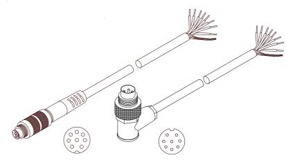
cab-las8/SPS-... (Länge max. 25m, Mantel: PU)
