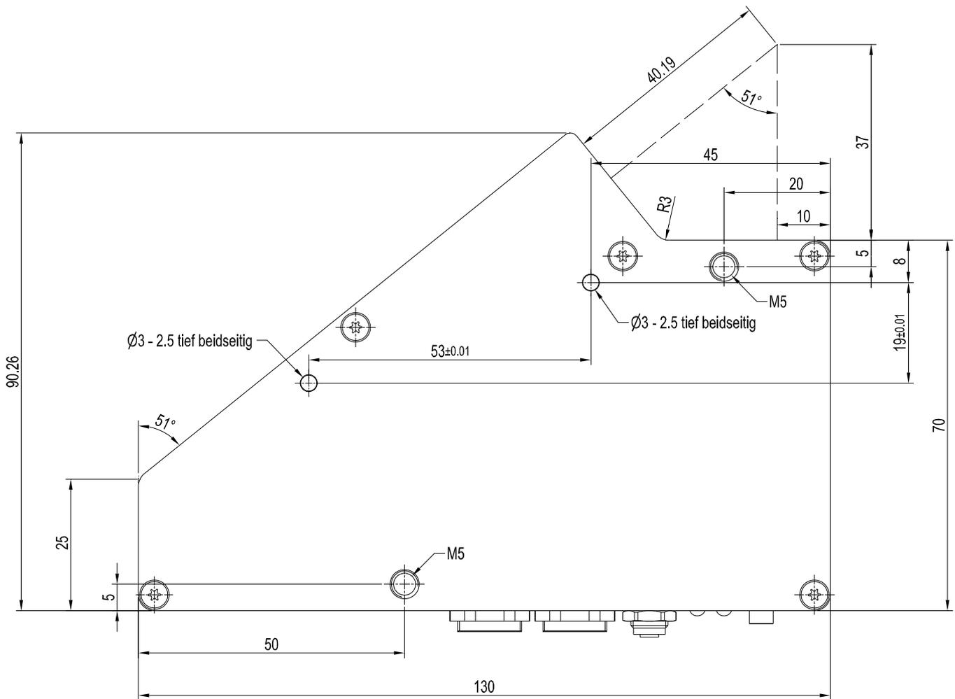
Alle Abmessungen in mm
